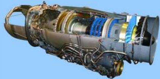
Pour entraîner le compresseur, une turbine absorbe une part de l'énergie d'éjection des gaz. La compression de l'air augmente le débit-masse et par conséquent la poussée.
